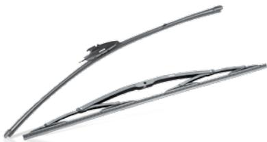
Tradizionali o Flat Blade, sono studiate appositamente per ogni tipo di veicolo, aderiscono perfettamente imprimendo una pressione uniforme sul parabrezza senza lasciare striature o aloni. Grande resistenza e silenziosità in ogni condizione d'utilizzo.
